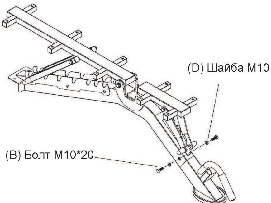
Закрепите переднюю опору (6) к раме (3) с помощью двух болтов M10\*20 (B) и двух шайб M10 (D).
