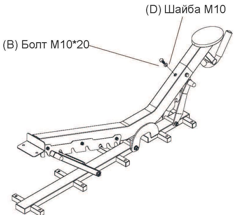
Переверните основную раму опорой вверх. Вкрутите болт M10\*20 (В) шайбу M10 (Д).
