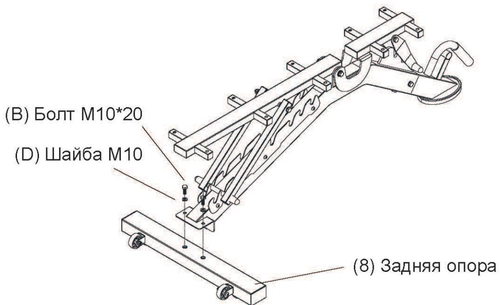
Прикрепите заднюю опору (8) к основной раме с помощью двух болтов M10\*20 (В) и двух шайб M10 (Д).
