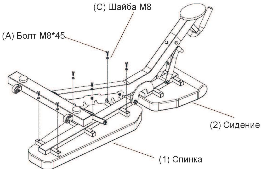
Переверните основную раму опорами вверх. Прикрепите спинку (1) к раме (3) с помощью 6 болтов M8\*45 (А) и 6 шайб M8 (С).
